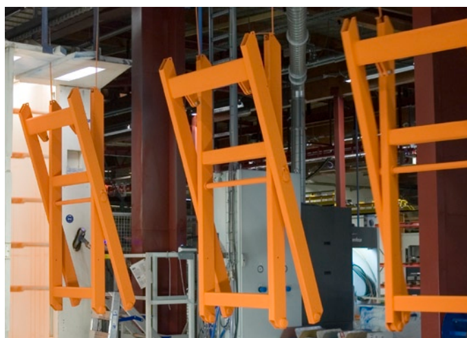
Fertig beschichtete Scheren verlassen die Beschichtungsanlage
