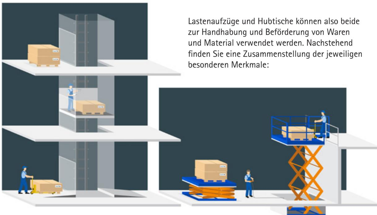
Lastenaufzüge und Hubtische können also beide zur Handhabung und Beförderung von Waren und Material verwendet werden. Nachstehend finden Sie eine Zusammenstellung der jeweiligen besonderen Merkmale:
